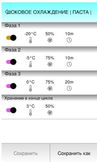
При выборе, например, игольчатого зонда открывается экран, на котором можно персонализировать программу, выбирая для каждого этапа температуру, вентиляцию, температуру в глубине продукта (при выборе игольчатого зонда) или продолжительность цикла (при выборе времени или вакуума). Можно также подключить хранение по завершении различных этапов.
